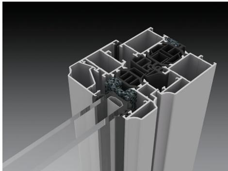
Hermes is een 3-kamer raam- en deursysteem in hoogwaardig aluminium dat een verhoogde kwaliteit biedt qua stabiliteit gecombineerd met een extreem hoge isolatiewaarde. Zowel kader- als vleugelprofielen zijn vooraan voorzien van een supplementaire derde kamer met extra hoekverbinding die een verhoogde stevigheid bieden. Geschikt voor gebouwen waar de toepassing van geïsoleerde ramen niet noodzakelijk is zoals inkomportalen van commerciële centra, binnenwanden van kantoren,...
