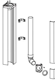
**Remarque :** l'évacuation des eaux par le montant est positionnée au moment du montage ! Les montants extérieurs sans évacuation des eaux de pluie par les montants reçoivent automatiquement un trop-plein dans les montants pour une évacuation de secours de l'eau du chéneau.
